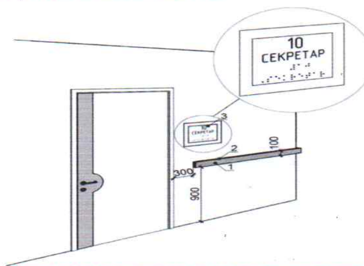
Рисунок 37 - Приклад розміщення тактильних інформаційних показників приміщень 1 - інформаційна направляюча; 2 - тактильна інформаційна позначка; 3 - інформаційна тактильна табличка, що дублює текстову інформацію у тактильному вигляді пласко друкованого тексту та шрифтом Брайля
